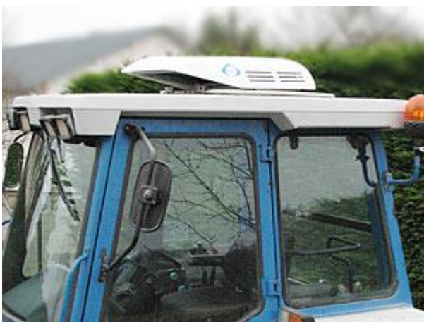
Système de climatisation en seconde monte sur tracteur
